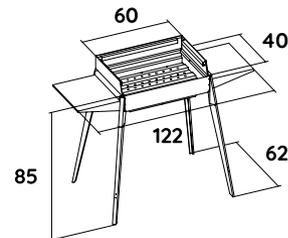
Modello base della serie ETNA. Barbecue realizzato totalmente in Acciaio Inox AISI 430.
