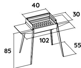
Barbecue di dimensioni ridotte interamente realizzato in Acciaio Inox Aisi 430.
